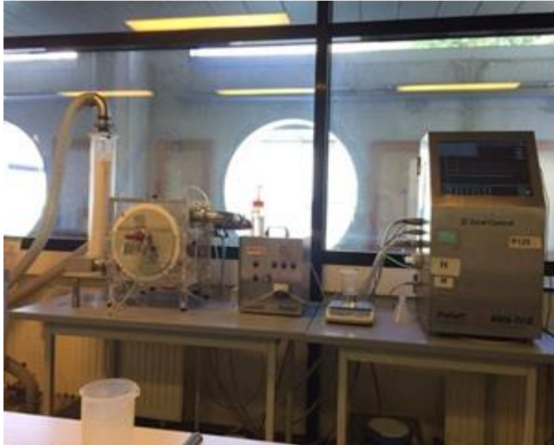
Figure 15 : Pelliculeuse à turbine perforée Procept®
