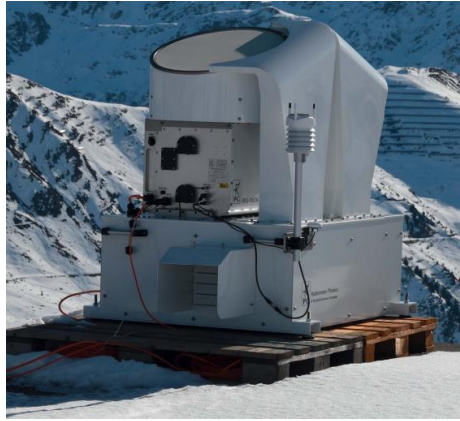
Figure I. 8 : Système de radar en bande W pour la surveillance de neige et précipitations [12]
