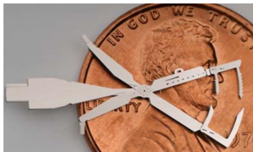
Figure II. 27 : Exemples de structures fabriquées avec le procédé EFAB : Pince chirurgicale [84]
