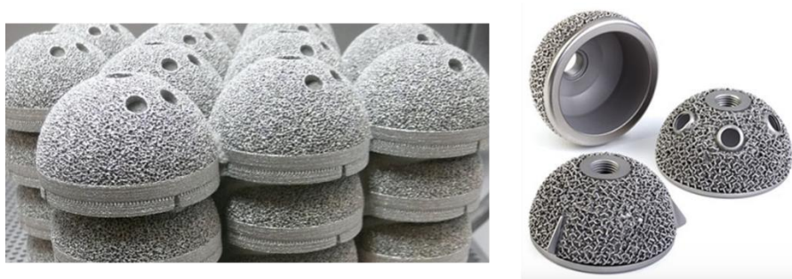
Figure II. 9 : Cotyles fabriqués par EBM pour les arthroplasties de la hanche [61]
