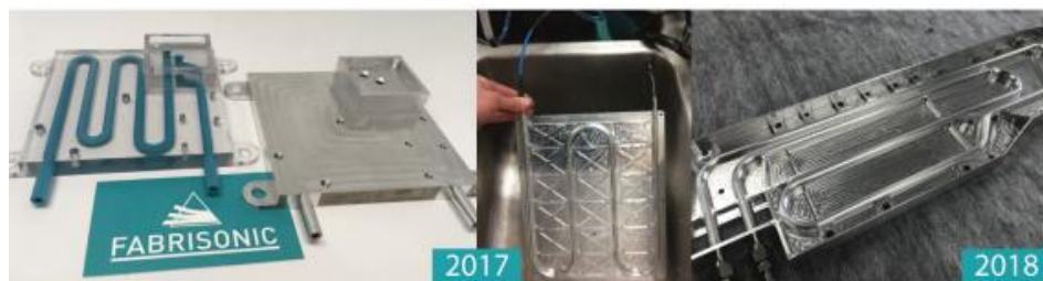
Figure II. 13 : Échangeur de chaleur fabriqué par UAM [67]
