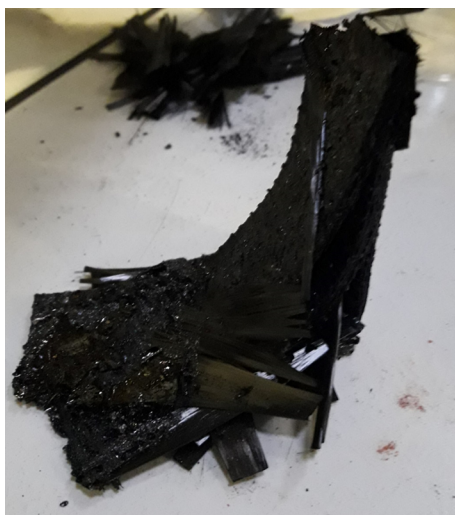
Figure 4.3 – Solide résiduel récupéré à la fin de l'essai MVA-565_60_NP (MVAP). Essai de pyrolyse avec un palier d'une heure à 565°C et introduction des échantillons par la vanne guillotine
