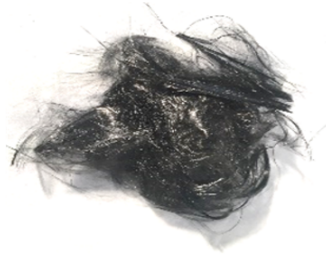
Figure D.1 – Aspect des fibres de carbone recyclées issues du composite unidirectionnel PA6
