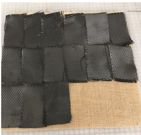
Figure 2.11 – Association des deux renforts (tissus de jute et rCF) pour la formulation du composite hybride à matrice PA6
