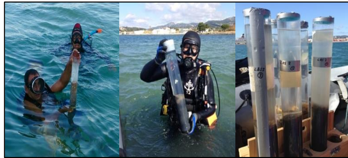
Figure II-3: Prélèvements des carottes sédimentaires maintenues verticalement afin d'éviter la perturbation de l'interface sédiment - eau (El Houssainy).
