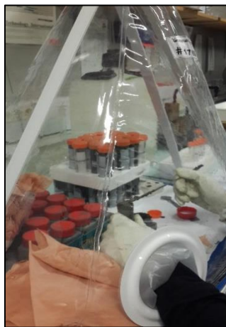
Figure II-4: Prélèvements des sédiments et des eaux interstitielles sous atmosphère inerte (El Houssainy).
