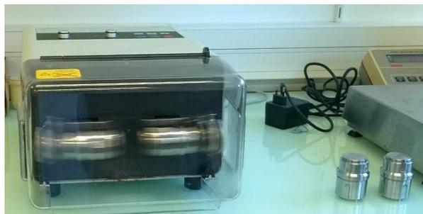
Figure 37 : Broyeur à boules MM 301 de chez Retsch en fonctionnement
