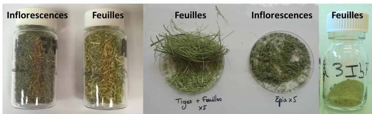
Figure 36 : A gauche échantillons obtenus avec un broyeur de type couteau ; au centre échantillons broyés avec le broyeur du CRIEPPAM, à droite échantillon de feuille broyé avec un broyeur à billes
