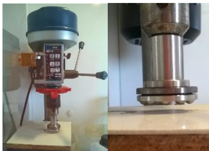
Figure 35 : Broyeur fabriqué par le CRIEPPAM dans son intégralité à gauche, et à droite la tête de broyage
