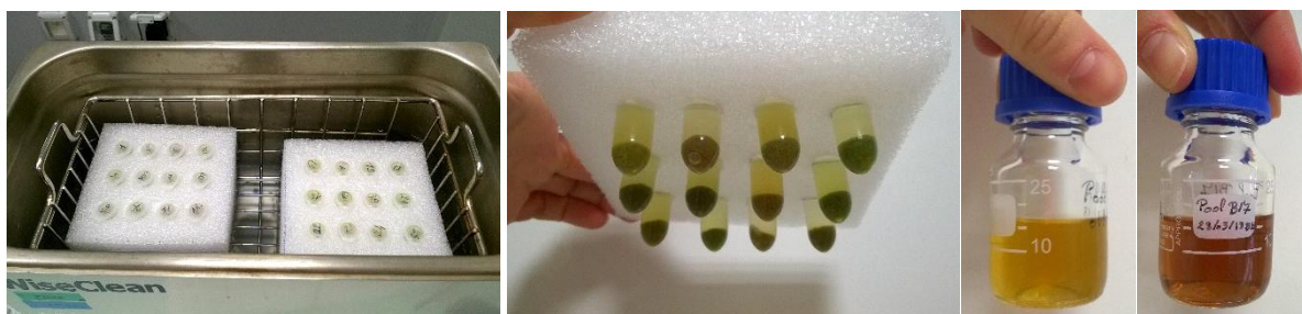
Figure 108 : De gauche à droite, photographie du bain à ultra-sons lors de la réalisation de deux jeux d'extraction en simultanément, photographie d'une plaque d'extraction vue de dessous à droite, pool des extraits de feuille de lavande, et pool des extraits d'inflorescences de lavande.
