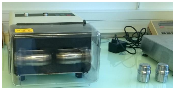
Figure 37 : Broyeur à boules MM 301 de chez Retsch en fonctionnement
