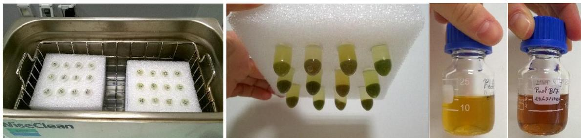
Figure 108 : De gauche à droite, photographie du bain à ultra-sons lors de la réalisation de deux jeux d'extraction en simultanément, photographie d'une plaque d'extraction vue de dessous à droite, pool des extraits de feuille de lavande, et pool des extraits d'inflorescences de lavande.
