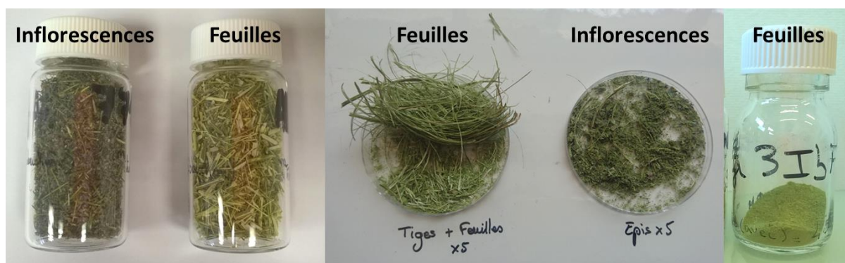
Figure 36 : A gauche échantillons obtenus avec un broyeur de type couteau ; au centre échantillons broyés avec le broyeur du CRIEPPAM, à droite échantillon de feuille broyé avec un broyeur à billes
