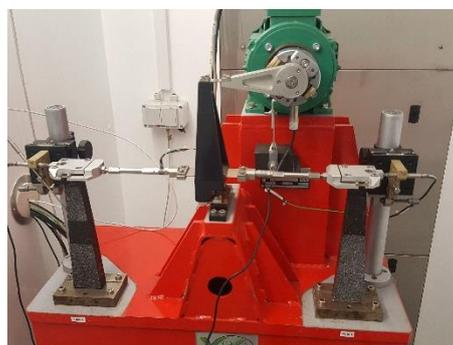
b) Machine de fatigue à l'IFSTTAR-Nantes
