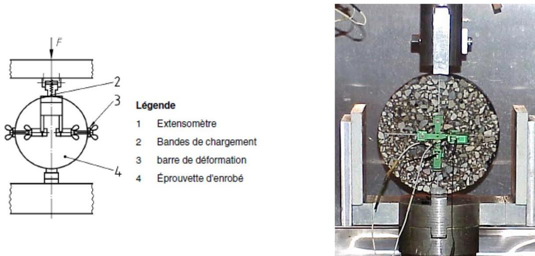
a) Principe de l'essai (NF EN 12697)
