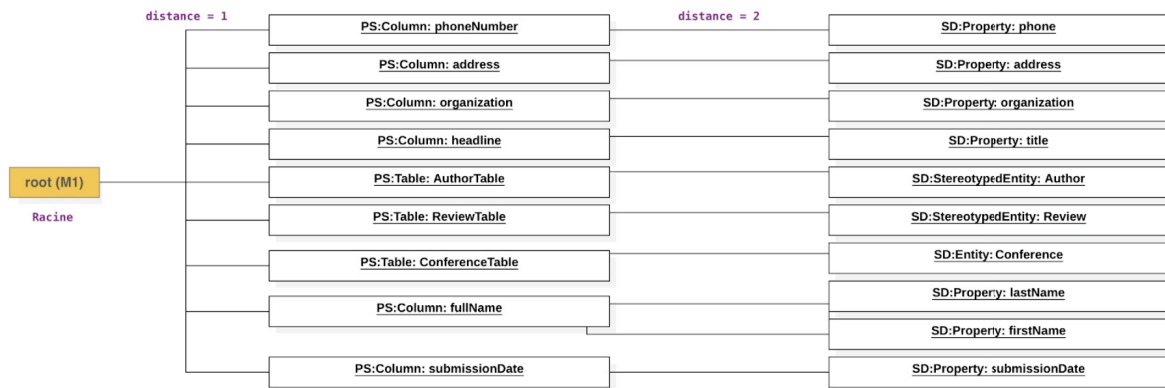
FIGURE B.2 – Graphe de dépendances associé à la suppression du modèle PS du CMS.
