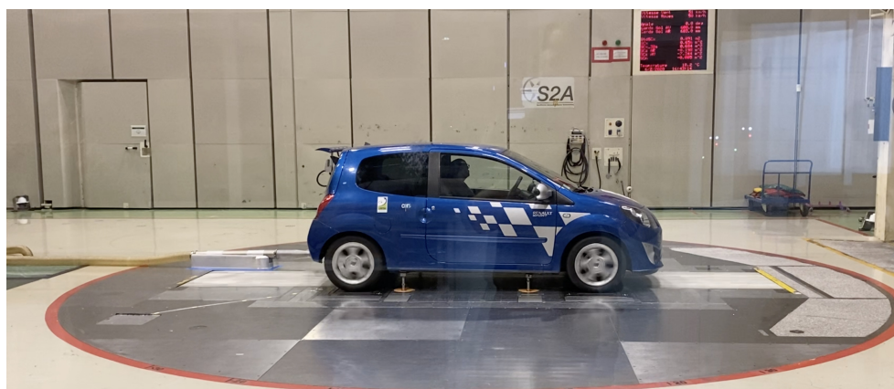
FIGURE (2.19) Installation de la twingo GT dans la soufflerie S2A pour l'équilibrage sur la balance aérodynamique.
