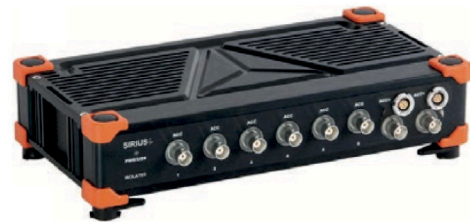
FIGURE (2.3) Représentation du boîtier Dewesoft Sirius utilisé pour les essais .
