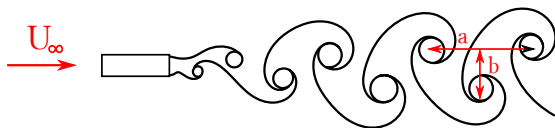
FIGURE (1.6) Représentation du lâché tourbillonnaire de type Von Kármán ( Y. Eulalie [41] ).
