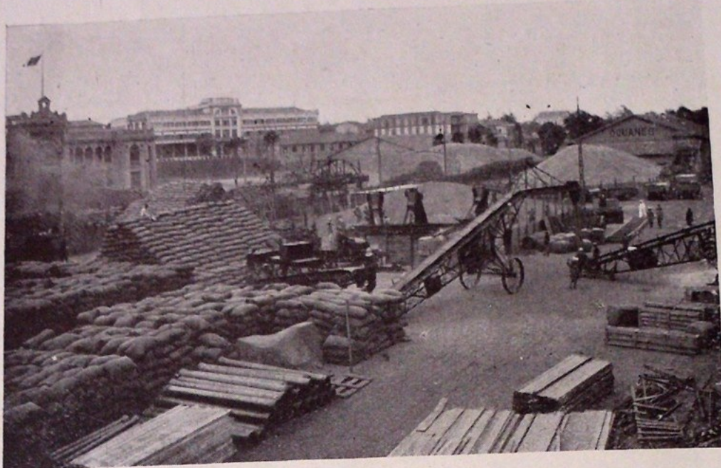
Le Port de Dakar. — Vue d'ensemble des appareils de chargement mécanique des arachides
