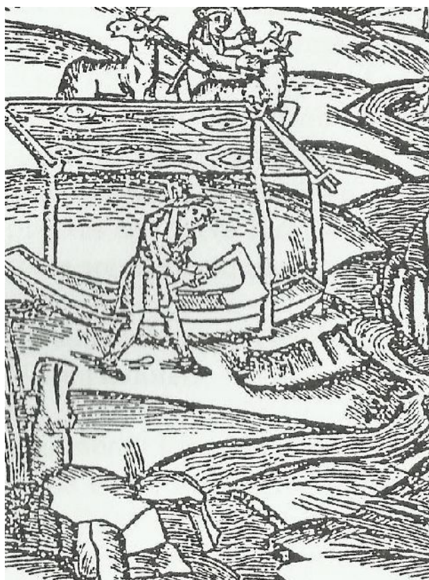
Figure 133 Détail d'une gravure des Géorgiques de Virgile, édition de J. Grüningen, Strasbourg 1502 (Rieth 1998) on l'on distingue la taille d'une pirogue monoxyde à la hache, sous un toit qui protège aussi bien la pirogue que l'artisan.
