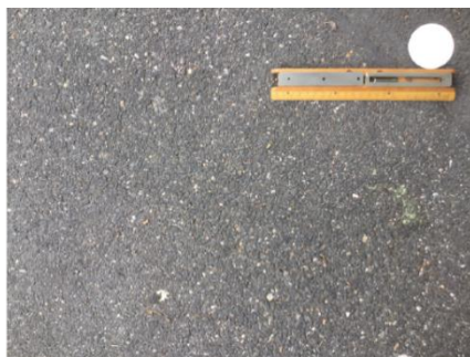
Figure 12-4 – Photographie de revêtement avec étalon de couleur et règle de mesure
