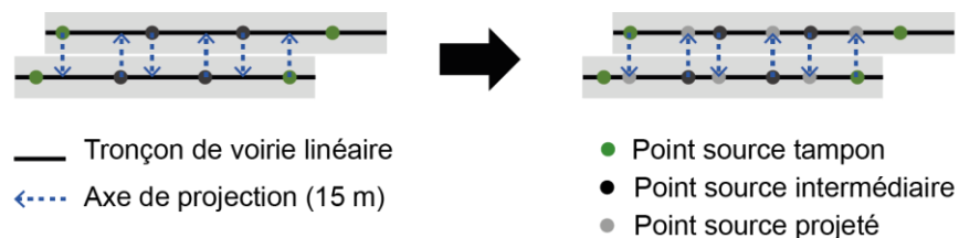
Figure F-13 – Projection des points sources (tampons et intermédiaires) entre un tronçon A et un tronçon B
