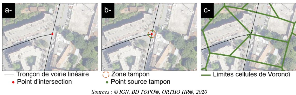
Figure F-6 – Diagramme de Voronoï à partir de points intermédiaires selon une distance uniforme aux intersections
