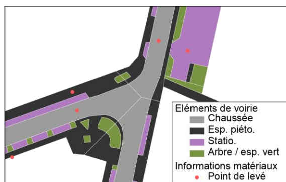
Figure 15-1 – Exemple de répartition des points de levé
