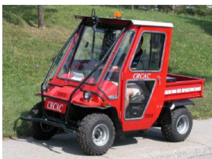
Figure 11-5 – Exemple de véhicule pour l'auscultation visuelle des trottoirs
