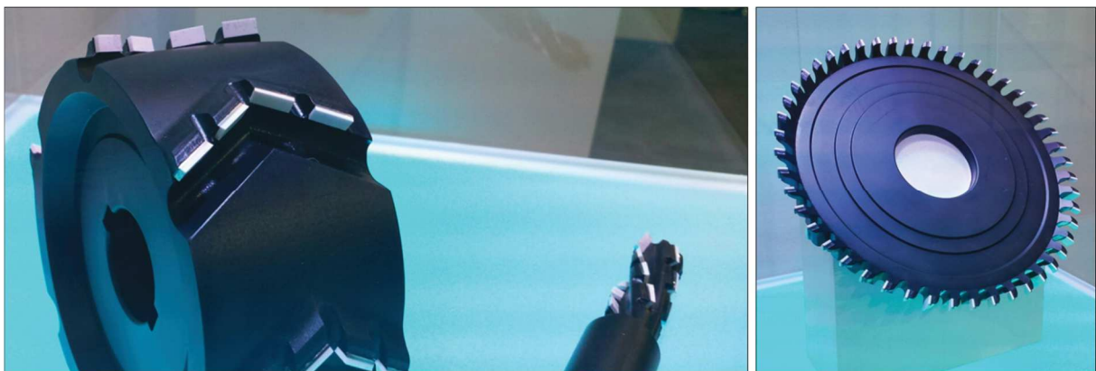
Figure 2: Photographie d'outils prototypes en céramique au salon du bois LIGNA , à Hanovre. A gauche, deux outils de fraisage, et à droite un décheteur
