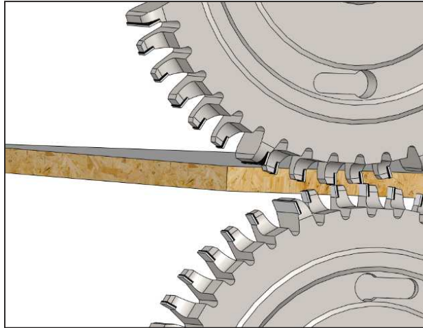
Figure I-6: Illustration de deux déchiqueteurs compacts utilisés pour enlever les surplus de matière et de décor
