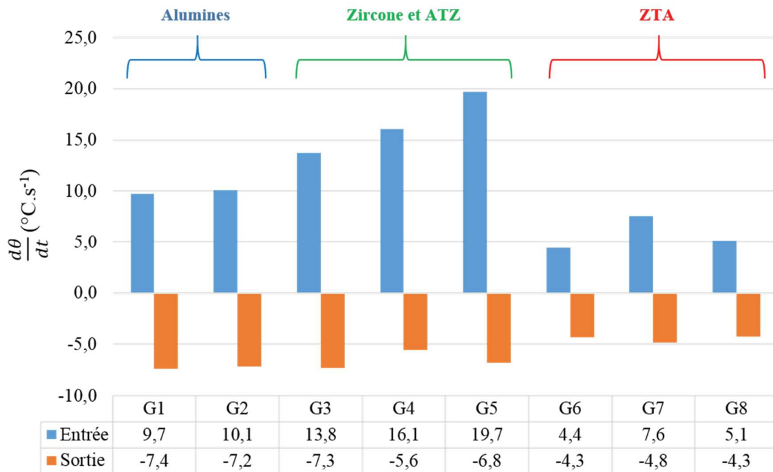
Figure IV-10: Variation de température des faces de coupe lors de l'entrée dans les zones denses du cylindre en MDF
