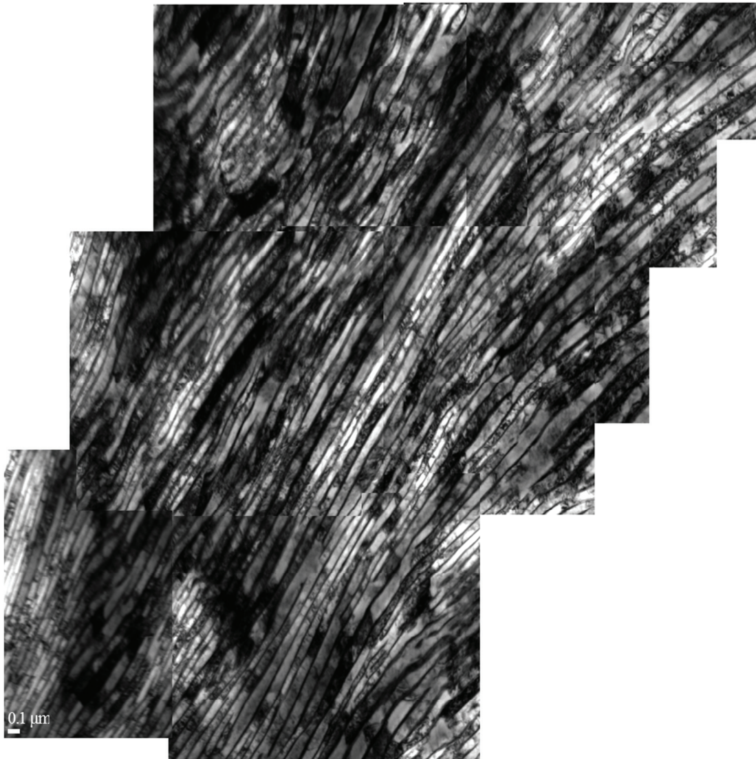
Figure 35 : Panorama de la microstructure perlitique fine de l'acier A1 (Plan T l -T c ).
