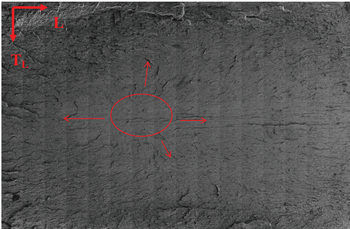
Figure 151 : Blister observé après ouverture d'un fil d'acier A2 dans le plan L- T_L . Zone d'initiation de la fissuration entourée en rouge et propagation selon les flèches.
