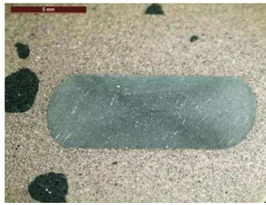
Figure 25 : Observation de la croix de laminage dans le plan T_L-T_C de l'acier A1 (section de l'acier 14 \times 6 mm)
