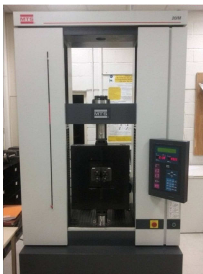
Figure 18 : Dispositif de cisaillement monté sur la machine MTS.
