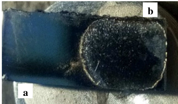
Figure 17 Eprouvette de TA6V, polissage miroir (a), polissage électrolytique (b).
