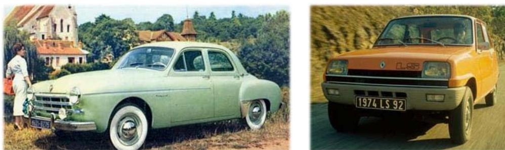
**Figure I.1. A gauche, Renault Frégate de 1959 dont le pare-chocs est en acier chromé. A droite, Renault 5 de 1980 avec bouclier en plastique.**
