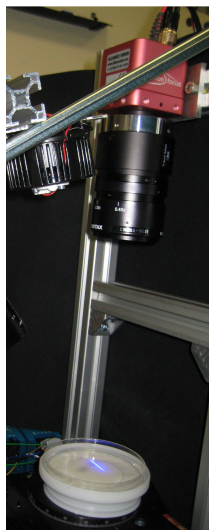
Figure 1.17 – Premier prototype d'acquisition équipé de la caméra Photonfocus choisie.
