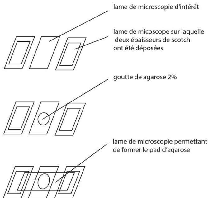
**Figure 14** : schéma de réalisation d'un pad d'agarose.
