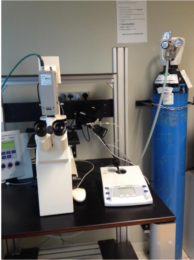
Figure 16 : ensemble du dispositif de micro injection du laboratoire de Sophie Jarriault.
