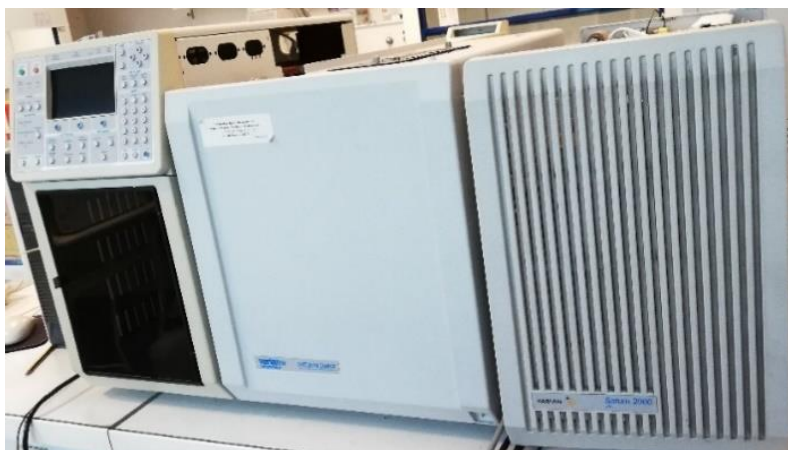
Figure 34 : Chromatographe en phase gazeuse (GC-Varian™) et spectromètre de masse à piège d'ions (MS-Saturn™)
