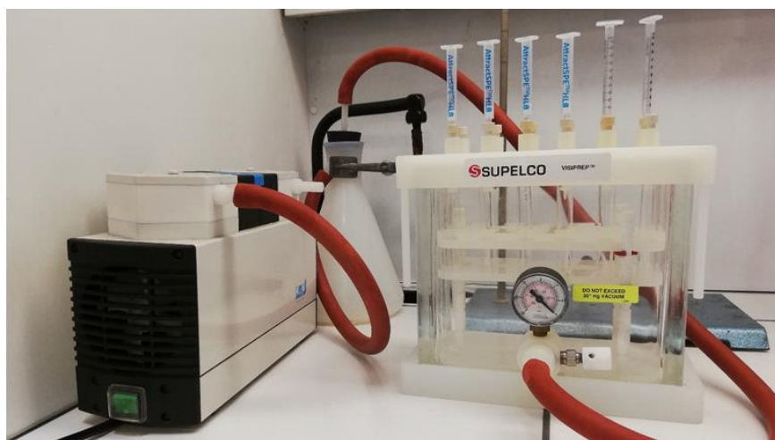
Figure 32 : Photographie du montage Visiprep utilisé pour la purification d'extraits QuEChERS par SPE
