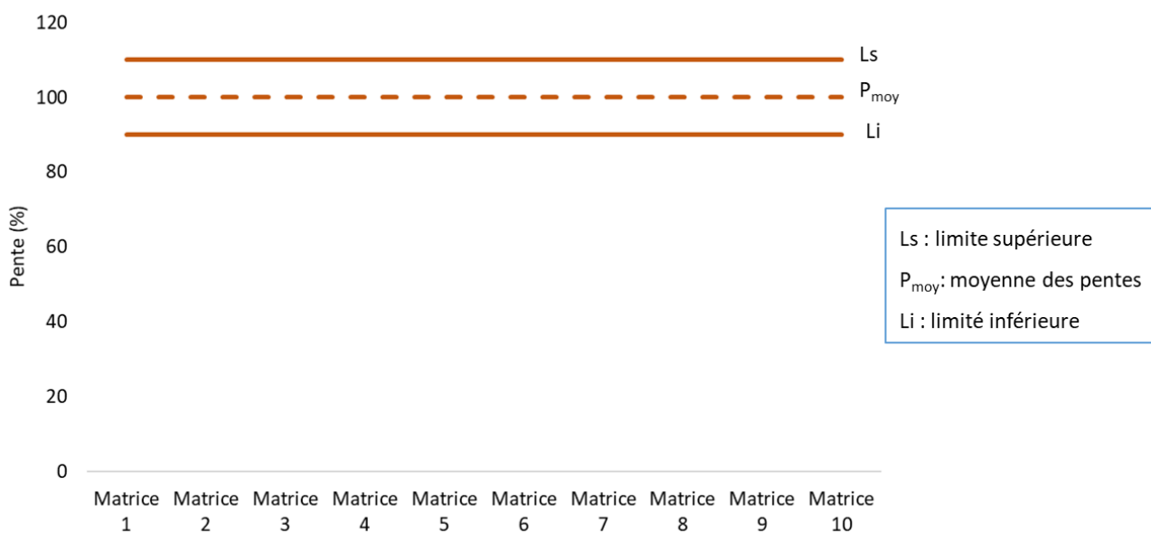
Figure 38 : Schéma d'évaluation de l'effet lié à la « matrice échantillon » présentant les limites d'acceptabilité des pentes obtenues
