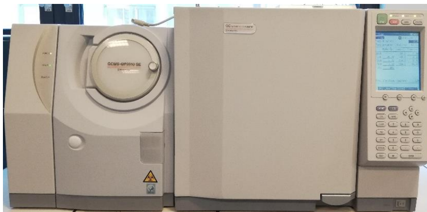
Figure 35 : Chromatographe en phase gazeuse (GC) et spectromètre de masse quadripolaire (MS) Shimadzu
