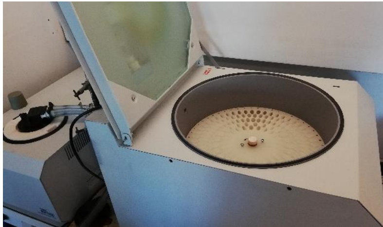
Figure 30 : Illustrations de l'évaporateur sous vide « SpeedVac™ » utilisé pour la concentration des extraits
