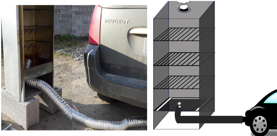
Figure 25 : Illustrations du montage utilisé pour l'exposition intentionnelle des échantillons végétaux (3 h) aux gaz d'échappement d'un moteur diesel
