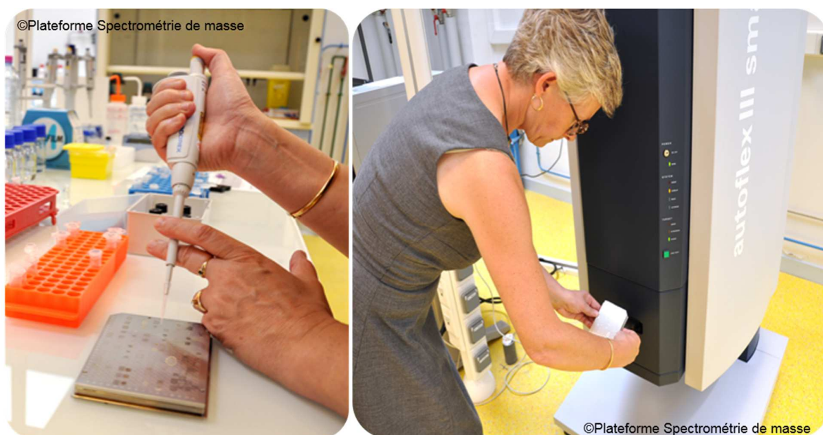
Figure 2-20 : Photographie de la plaque appelée cible (à gauche) ainsi que le spectromètre de masse MALDI-TOF/TOF de la plateforme de Spectrométrie de Masse de l'UBO (Autoflex III, Bruker, Etats-Unis) (à droite).
