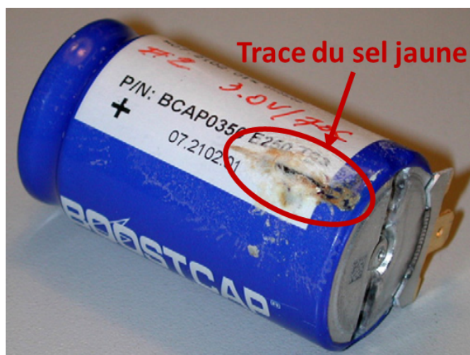
Figure III- 22 : Photo d'un supercondensateur Maxwell série BCAP0350 après un vieillissement à 3,0 V, 70 °C pendant 200 h [9].
