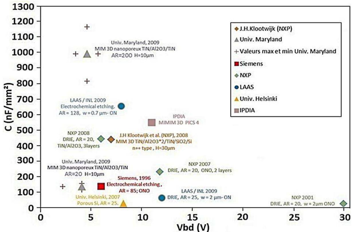
Figure I. 12 : Densité de capacité en fonction de la tension de claquage pour différentes structures capacitives 3D suivant l'aspect ratio et les diélectriques Al<sub>2</sub>O<sub>3</sub>, ON et ONO provenant de différents organismes [26]
