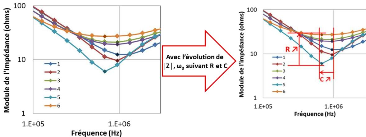
Figure IV. 10 : Module de l'impédance suivant la fréquence et la fréquence de résonance des différents démonstrateurs
