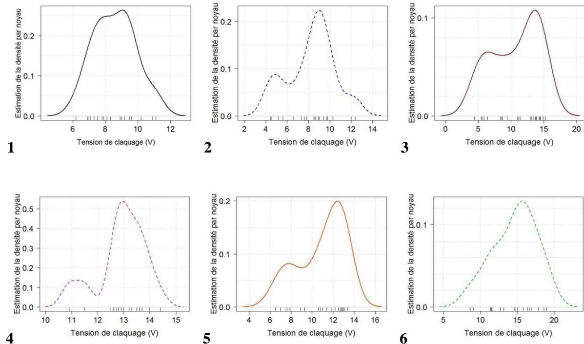
Figure IV. 6 : Estimation donnant la tendance des densités par noyau de la tension de claquage pour chaque démonstrateur de 1 à 6.
