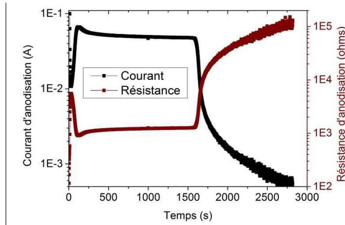
Figure III. 27 : Évolution du courant et de la résistance lors de la sur-anodisation longue
