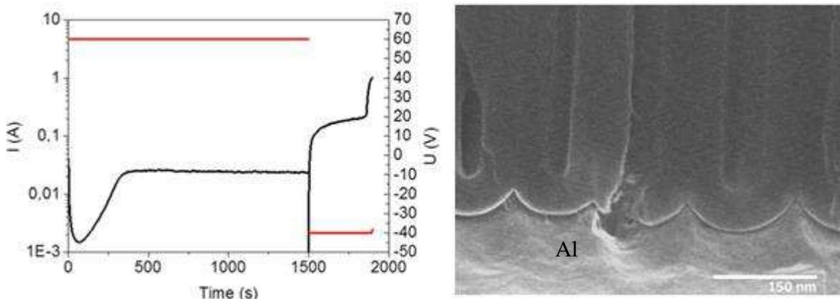
*Figure III. 32 : Anodisation 60V d'aluminium sur titane avec l'acide oxalique suivi d'un inversement de polarisation ou mode cathodique -40V en salle blanche et image MEB de la couche barrière d'alumine nanoporeuse sur aluminium*
