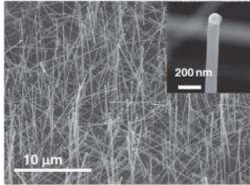
Figure I. 15 : Nanofils de silicium dopé n [46]
