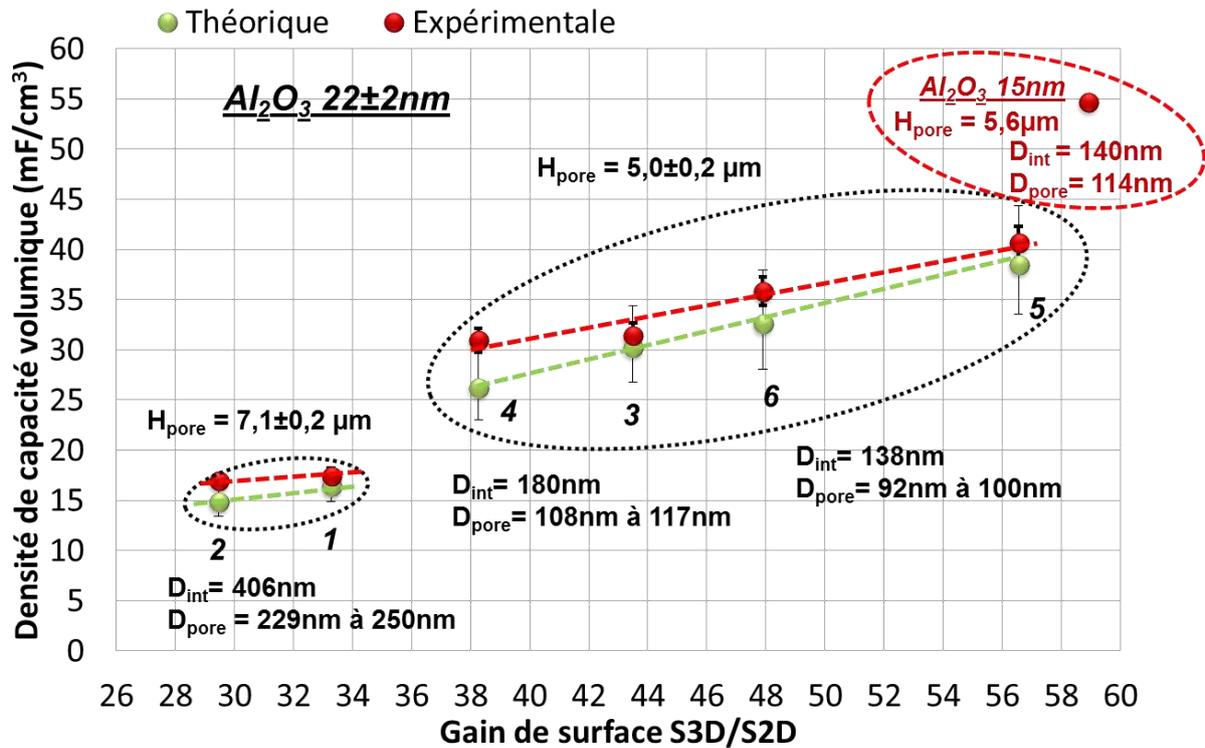
*Figure IV. 13* : Comparaisons des densités de capacité volumique théoriques et expérimentales en fonction du gain de surface théorique et suivant le diamètre de pore, la distance interpore et la hauteur de pore  $H_{pore}$  de la structure nanoporeuse
