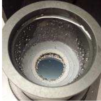
Figure III. 31: Image du dégagement gazeux au sein de l'acide oxalique dans la cellule suite aux réactions cathodiques
