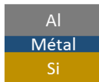
Figure III. 8 : Schéma représentatif de la couche métallique intermédiaire entre l'aluminium et le silicium
