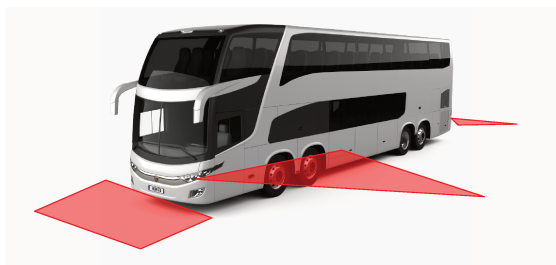
FIGURE 1 – Les angles morts où le conducteur du bus ne peut pas détecter visuellement les obstacles de la route en tant que les cyclistes
