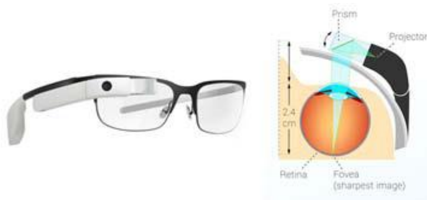
Figure 1-3 : Aspect des Google Glass et principe de fonctionnement [17].
