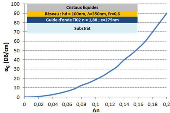
Figure 5-2 : Coefficients \alpha_g d'un GMRF (dimensions indiquées en haut à gauche) calculés en fonction du \Delta n du réseau de diffraction [182] [183].
