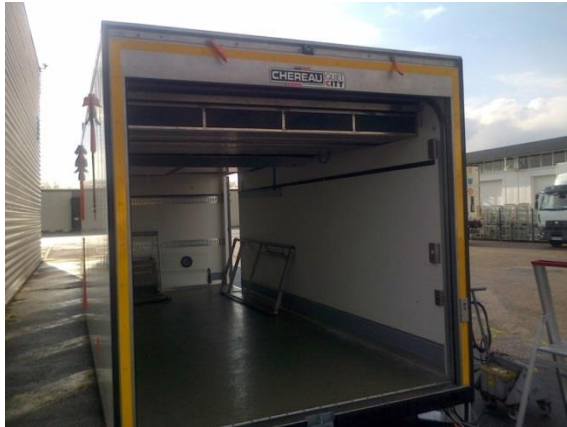
Figure 4.6 : Caisse frigorifique et dispositif de rideau d'air (rideau électrique ouvert).
