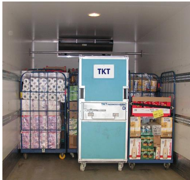
Figure 1.6 : Chargement d'une caisse frigorifique en conditions réelles.
