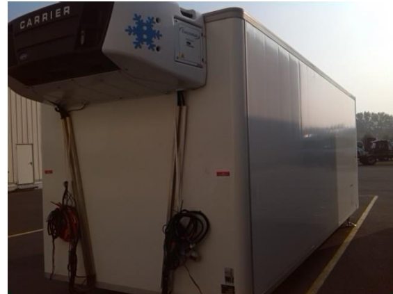
Figure 4.7 : Caisse et groupe frigorifiques.
