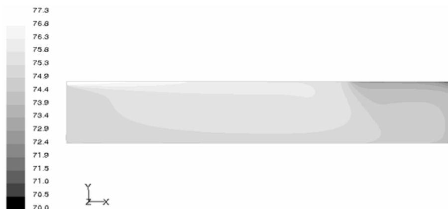
Figure 1.12 : Champ d'humidités relatives dans le plan de symétrie de la caisse (Ben Amara et al. 2007).
