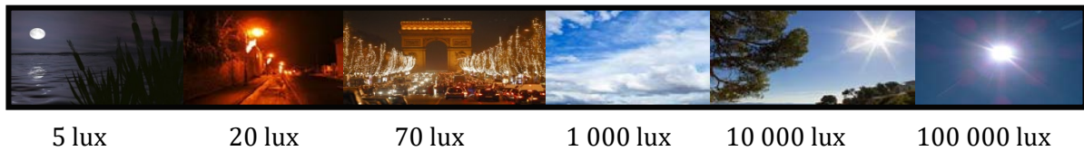
Figure 54 : Exemple de correspondance entre le niveau lumineux et les données chiffrées d'éclairement lumineux
