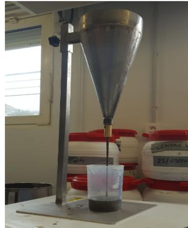
Figure. III.5 – Essai au cône de Marsh.
