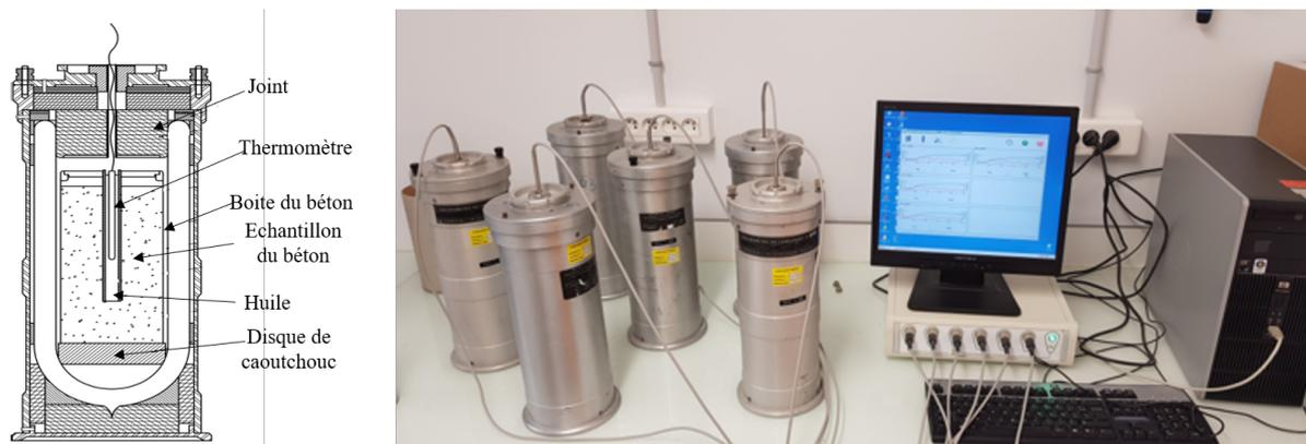
Figure. II.8 – Essai de la calorimétrie semi-adiabatique.
