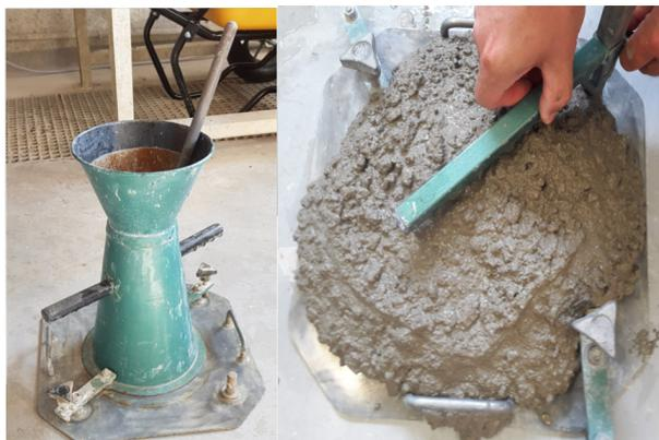
Figure. II.7 – Essai d'affaissement au cône d'Abrams.
