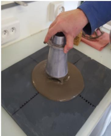
Figure. III.4 – Essai au mini-cône.
