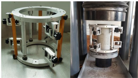
Figure. IV.3 – Dispositif de l'essai de module d'élasticité.
