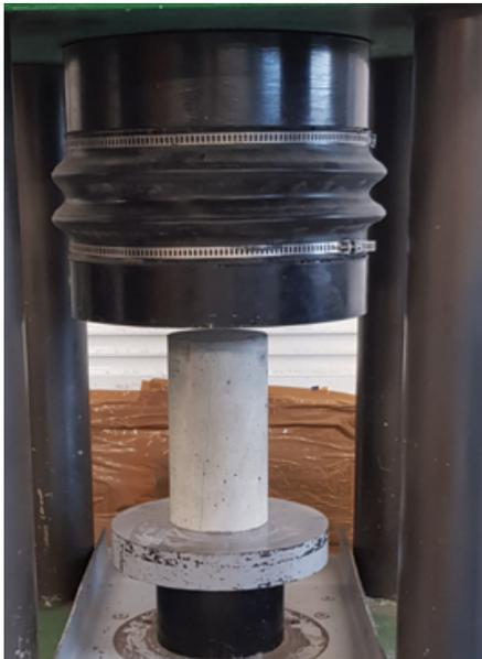
Figure. II.9 – Essai de la résistance à la compression.
