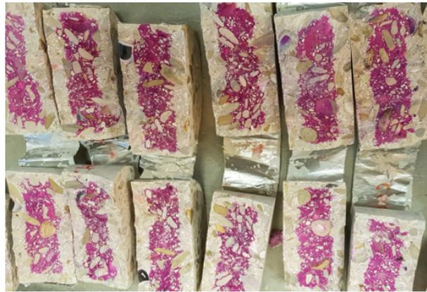
Figure. IV.17 – Épaisseur de la partie carbonatée des différents bétons après un mois dans une enceinte à 3%  $CO_2$ .
