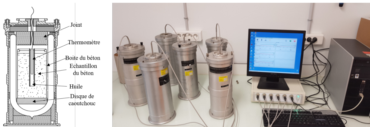
Figure. II.8 – Essai de la calorimétrie semi-adiabatique.
