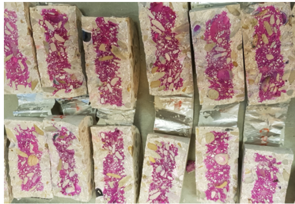
Figure. IV.17 – Épaisseur de la partie carbonatée des différents bétons après un mois dans une enceinte à 3% CO_2 .
