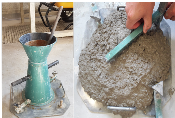
Figure. II.7 – Essai d'affaissement au cône d'Abrams.
