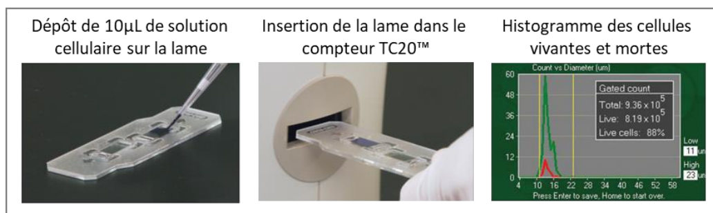
Figure 84 : Différentes étapes d’un comptage cellulaire automatisé (TC20™, Bio-Rad)
