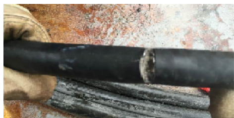
Figure 3: Défauts francs (image de gauche) et non francs (image de droite) apparaissant dans les réseaux de câblage.
