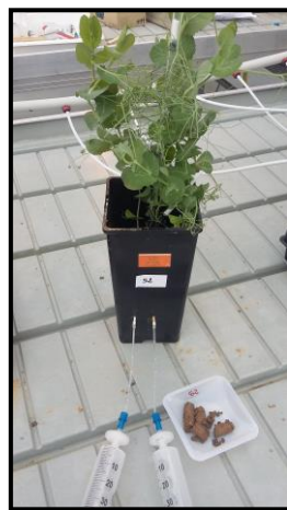
Figure 6. Le dispositif en Rhizom utilisé lors des expérimentations de collecte des exsudats racinaires
