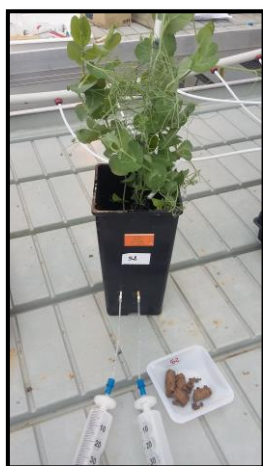
Figure 6. Le dispositif en Rhizom utilisé lors des expérimentations de collecte des exsudats racinaires
