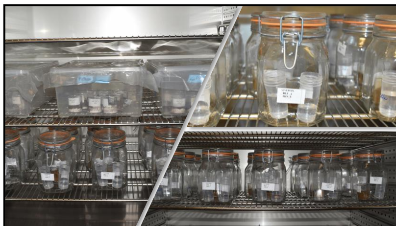
Figure 29. Mise en place des incubations en microcosmes pour l'étude de la cinétique de dégradation des résidus de cultures
