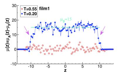
Figure 0-5: Distribution  $\mu(z) \equiv \mu_{\rm A}(z) - \mu_{\rm F}(z)$  du module de cisaillement pour le film1 et deux températures. Quand  $\mu(z)$  disparait dans la limite liquide ( cercles ouverts), il devient constant en dessous de  $T_{\rm g}$  avec un plateau dans la phase de volume au milieu des couches minces (ligne horizontale pointillée) prise en sandwich entre 2 couches plus flexibles marquées par les flèches.
