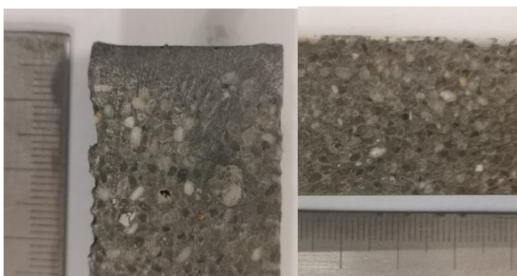
Figure A3.32 : Eprouvette de mortier binaire CEM I découpée dans le sens de la longueur.
