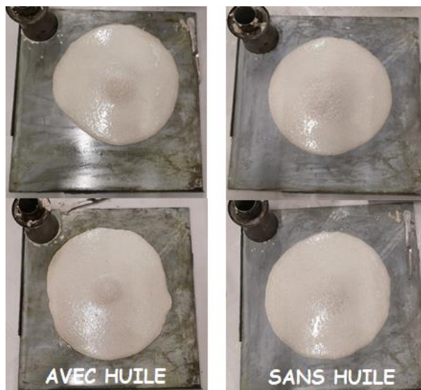
Figure A3.8 : Test d'étalement au mini cône sur des mortiers au CEM I blanc réalisé sur deux gâchées, avec huile (à gauche) ou sans huile (à droite)
