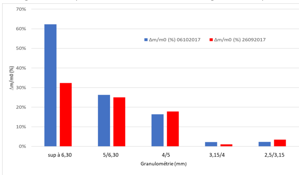
Figure II-18 : Variation relative de masse entre le 1er et le 4ème tamisage à la colonne \frac{\Delta m}{m_0} (exprimée en %) pour chaque classe granulaire étudiée de deux mélanges distincts à 50 % de ciment et 30 % d'eau. Le diamètre de tamis est exprimé en mm suivant l'axe des abscisses.
