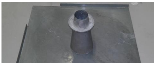
Figure A3.1 : Mini-cône tronconique de 14.5cm de haut, de 10cm de diamètre à sa base et de 5cm de diamètre à sa partie supérieure, utilisé sur plaque métallique posée sur une surface plane
