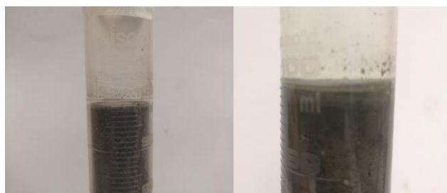
Figure A3.25 : A gauche, éprouvette graduée contenant le mortier référence CEM I à 24 heures de maturation. A droite, éprouvette graduée contenant le mortier référence CEM V à 24 heures de maturation
