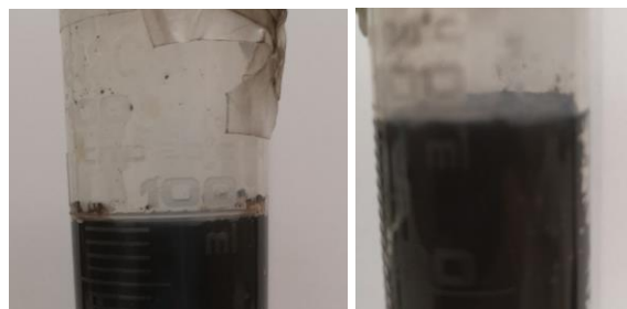
Figure A3.37 : Eprouvettes graduées, à 24 heures de maturation, contenant, à gauche, le mortier ternaire CEM V, E/C=0,48 et à droite, le mortier ternaire CEM V, E/C=0,50
