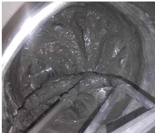
Figure II-7 : Photographie d'une pâte faite de 500 g de cendres volantes + 200 g de ciment CEM I avec 200 g d'eau, obtenue après avoir dépassé la limite d'ajout maximum d'eau (dépassement de l'état capillaire) lors d'un essai de granulation.
