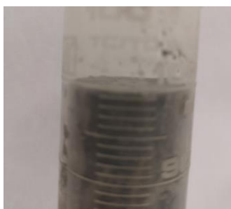
Figure A3.31 : Eprouvette graduée contenant le mortier binaire CEM I à 24 heures de maturation.
