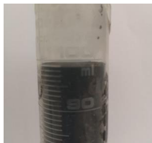
Figure A3.36 : éprouvette graduée contenant le mortier ternaire CEM I, E/C=0,54 à 24 heures de maturation
