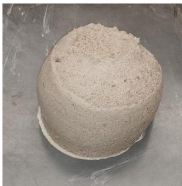
Figure A3.13 : Mortier normalisé au CEM I blanc avec un E/C=0.4 durant la mesure d'affaissement
