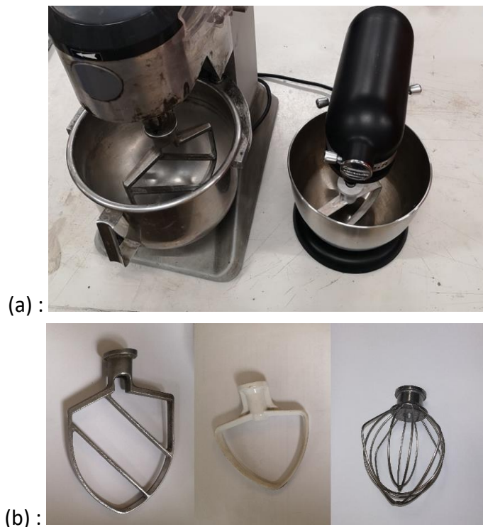
Figure II-6 : Photographie (a) : des deux malaxeurs (grande échelle à gauche et petite échelle à droite) et (b) : des accessoires des deux malaxeurs (pale de la grande échelle à gauche, pale de la petite échelle au milieu, et fouet de la petite échelle à droite).
