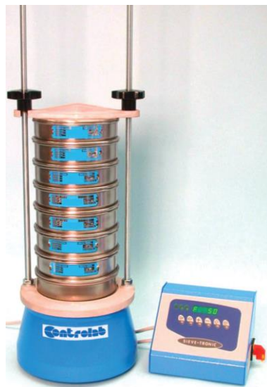
Figure II-8 : colonne à tamiser utilisée au laboratoire
