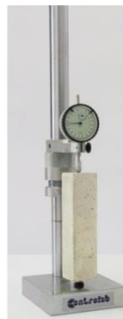
Figure A3.7 : Rétractomètre (Controlab, France) utilisé au laboratoire de Génie Civil de l'Ecole Centrale de Lille
