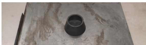
Figure A3.2 : Mini-cône de 5 cm de haut, de 10 cm de diamètre à sa base et de 7 cm de diamètre à sa partie supérieure, sur plaque métallique posée sur une surface plane
