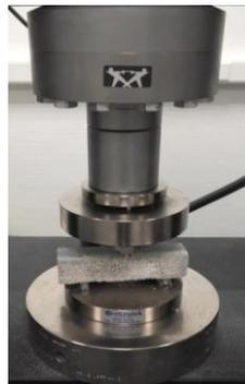
Figure A3.3 : Dispositif permettant de réaliser les essais sur éprouvette normalisée 4\*4\*16cm<sup>3</sup> en flexion trois points au laboratoire de Génie Civil de l'École Centrale de Lille
