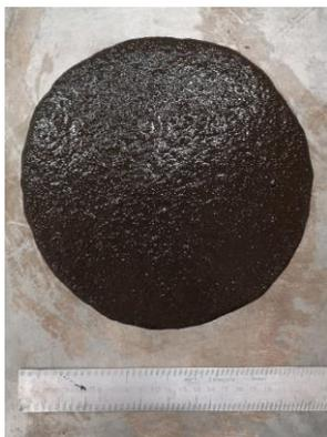
Figure A3.46 : Etalement au cône ASTM d'un mortier quaternaire CEM V ( $E/C=0,48$ ) contenant 10% de  $MnO_2$  par rapport à la masse totale sous forme de poudre et granules.
