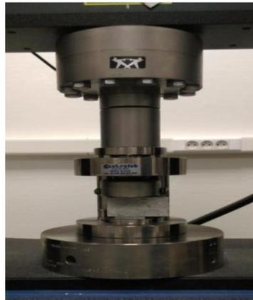
Figure A3.5 : Dispositif permettant de réaliser les essais en compression au laboratoire de Génie Civil de l'Ecole Centrale de Lille
