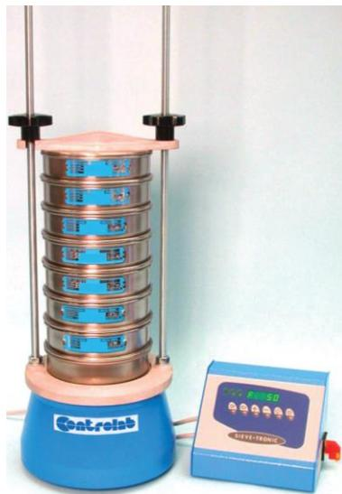
Figure II-8 : colonne à tamiser utilisée au laboratoire
