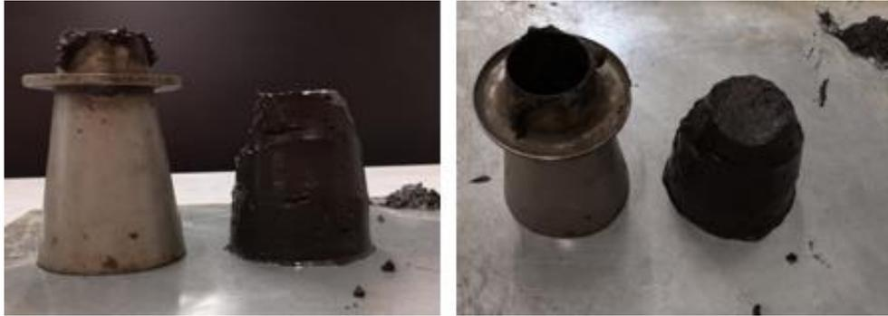
Figure III-12 : Pâte Portland du brevet, faite au  $MnO_2$ , durant la mesure de l'affaissement
