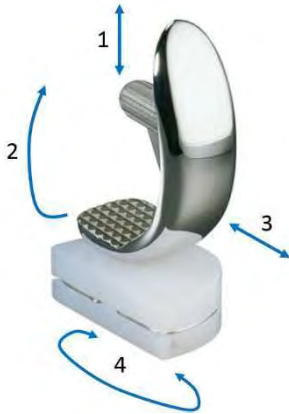
Figure IV-1 Convention des signes pour certains paramètres qui interviennent lors de la simulation de marche : 1- force normale, 2-flexion de la composante fémorale, 3-déplacement AP et force AP, 4-rotation tibiale et couple de rotation tibiale
