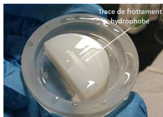
Figure IV-23 Visualisation macroscopique de la trace de frottement au niveau de l'implant en UHMWPE après frottement en présence de Sérum+
