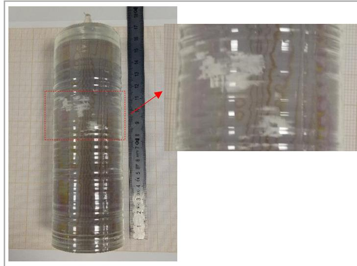
**Figure II.17** Monocristal de LMO « LMO-5N-1 » tiré par la méthode Czochralski.
