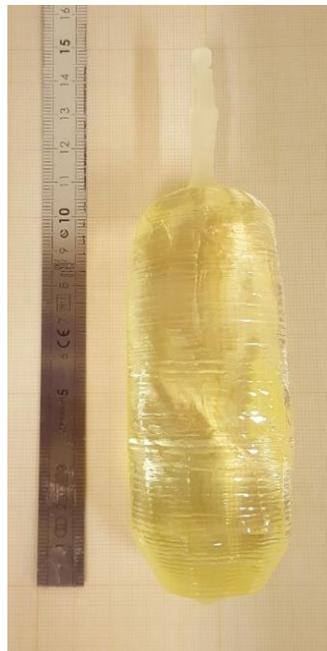
**Figure II.24** Monocristal de LMO « LMO-3N-2 » tiré par la méthode Czochralski.
