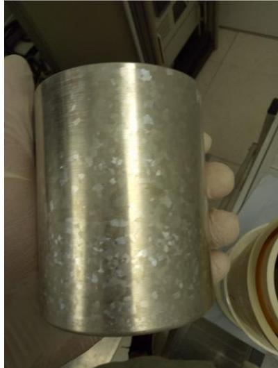
**Figure II.12** Creuset en platine (Ø80 mm) à 99,99 % après quelques essais de chauffe jusqu'à ~800 °C.
