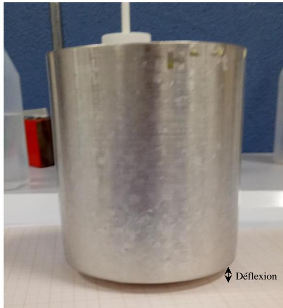
**Figure II.25** Creuset en platine bombé après le tirage de LMO-5N-1.
