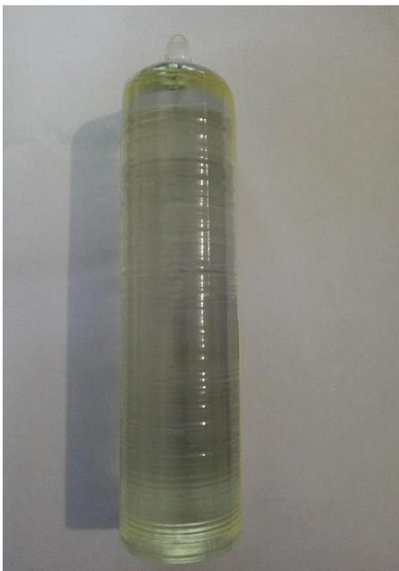
**Figure II.26** Monocristal de LMO « LMO-5N-2 » de diamètre 50mm, tiré par la méthode Czochralski.
