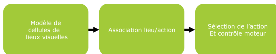
FIGURE 5.1 – Architecture du modèle PerAc. Le modèle de cellules de lieu visuelles recrute des lieux qui sont ensuite associés à des actions par une seconde partie du système. Une troisième partie s'appuie sur cette représentation lieu/action pour sélectionner l'action à mener et génère la consigne associée.
