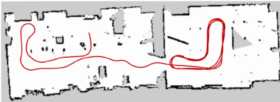
FIGURE 2.4 – Un exemple de représentation sous forme de grille d'occupation avec, en rouge, le trajet parcouru par le robot [Bellekens et al. 2015].
