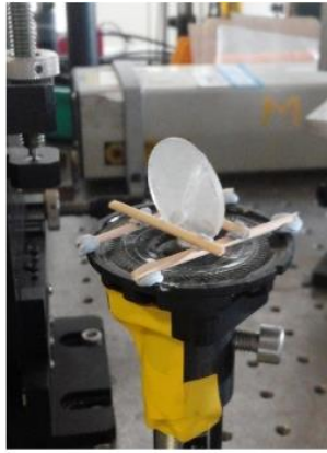
Figure 98 : Implantation du diffuseur sur un haut-parleur (à gauche) et schéma montrant le mouvement du diffuseur et du cône du haut-parleur (à droite).
