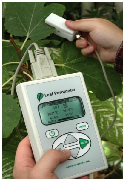
Figure 7 : Mesure de la conductance stomatique des feuilles par un poromètre.
