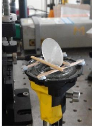
Figure 98 : Implantation du diffuseur sur un haut-parleur (à gauche) et schéma montrant le mouvement du diffuseur et du cône du haut-parleur (à droite).
