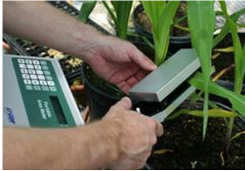
Figure 11 : Mesure de la surface foliaire par planimètre.
