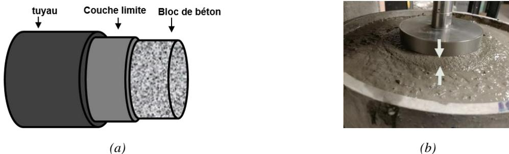
Figure 2-9: La couche limite dans : (a) le tuyau de pompage et (b) le tribomètre
