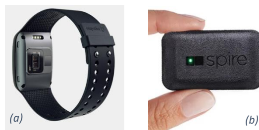
Figure 3.4 – Dispositifs portables de mesure PPG. (a) Empatica E4 (b) Spire Health Tag
