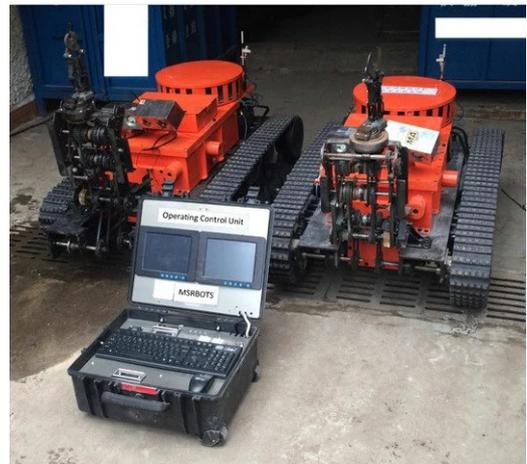
FIGURE 2 – Système multi-robots MSRBOTS déployé dans le cadre de missions de recherche et sauvetage prenant place dans des mines de charbon [59].
