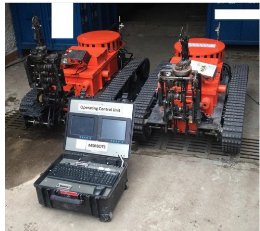
FIGURE 2 – Système multi-robots MSRBOTS déployé dans le cadre de missions de recherche et sauvetage prenant place dans des mines de charbon [59].
