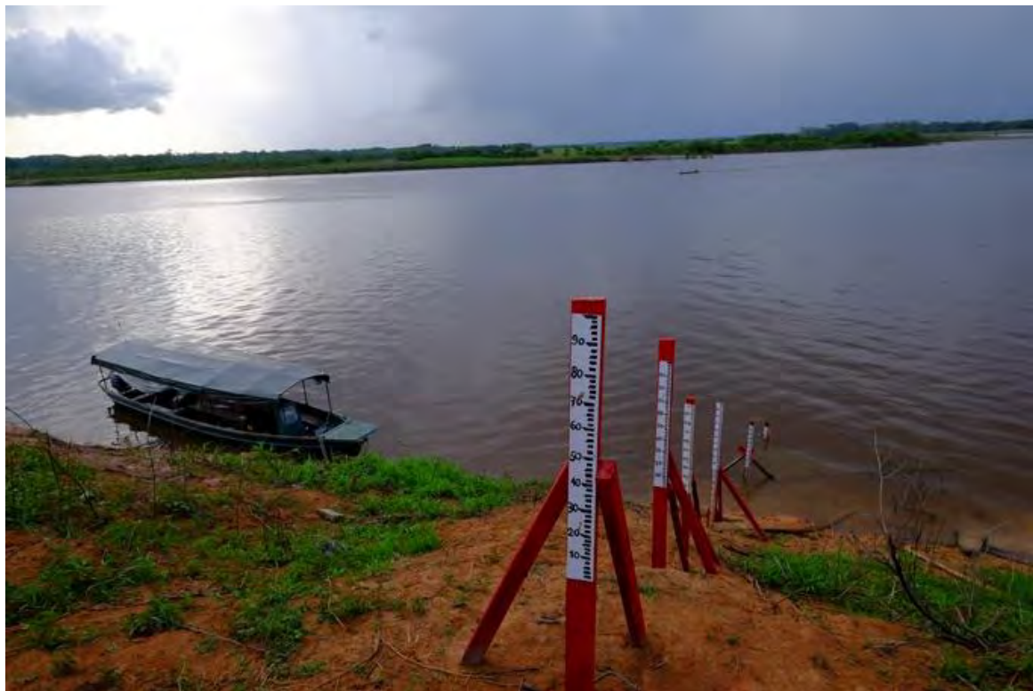
Photographie 2.11: Echelle limnimétrique de la station hydrométrique de Requena (Ucayali), appartenant au SENAMHI, et maintenue par les équipes IRD-SENAMHI du SO HyBAm au Pérou. L'échelle est placée à la confluence des rios Tapiche et Ucayali, aujourd'hui coté Tapiche car l'avancée du bras de terre entre le Tapiche et l'Ucayali a fini par repousser l'Ucayali. Les règles sont en bois, fabriquées de la main habile de l'observateur de Tamshiyacu (Amazone) : les éléments en aluminium sont souvent volés.
