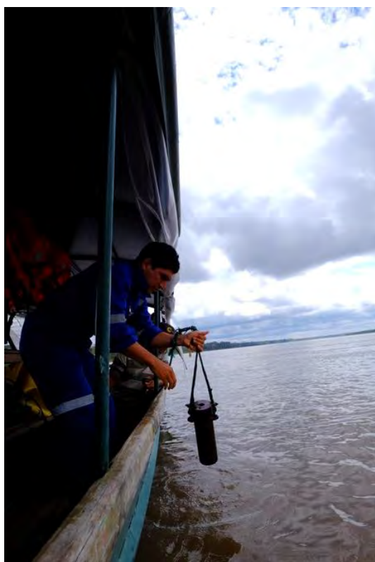
Photographie 2.10: (a) Echantillonneur de type rising-stage utilisé lors des campagnes du SO HyBAm au Pérou. (b) Résultats d'un jaugeage solide à Requena en juillet 2015: 24 échantillons prélevés sur la section plus un échantillon de sables du lit de la rivière pour analyse granulométrique. Crédits : Nadia Santini-Liveau
