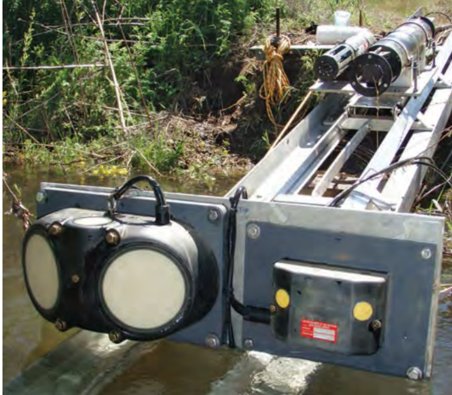
Photographie 2.4: Exemple de montage d'appareil de mesure indirecte de concentration en MES sur la rivière Clearwater à Spalding, aux Etats-Unis (Idaho). Au premier plan un aDcp horizontal (mesure acoustique de l'absorption), au second plan, à gauche une sonde de turbidité (néphélomètre mesurant la lumière diffusée à un angle de 90° par rapport à la lumière incidente) et à droite une sonde LISST (mesures optiques, fournissant la concentration des particules et leur distribution en taille). Source : https://pubs.usgs.gov/fs/2014/3038/pdf/fs2014-3038.pdf
