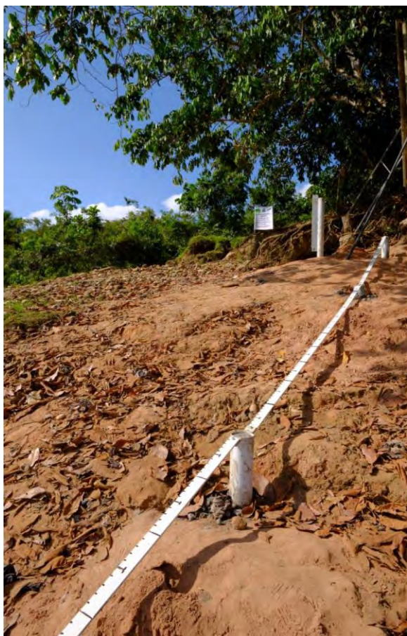
Photographie 2.12: Echelle limnimétrique de la station de Lagarto (Ucayali). Une règle inclinée a été installée de façon à éviter les chocs avec les troncs d'arbre descendant la rivière avec une grande quantité de mouvement en crue et qui détruisaient systématiquement les éléments d'échelles. Le marnage de la rivière dépasse les 8 m au droit de cette station.
