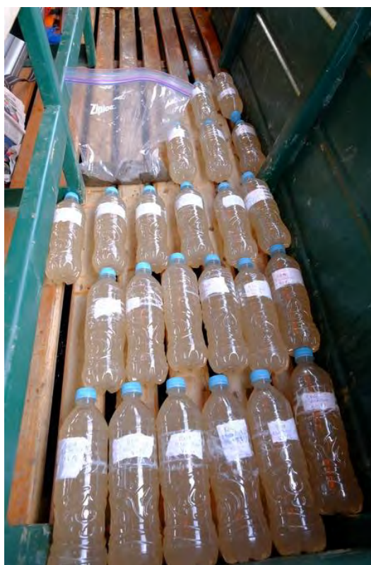
Photographie 2.10: (a) Echantillonneur de type rising-stage utilisé lors des campagnes du SO HyBAm au Pérou. (b) Résultats d'un jaugeage solide à Requena en juillet 2015: 24 échantillons prélevés sur la section plus un échantillon de sables du lit de la rivière pour analyse granulométrique. Crédits : Nadia Santini-Liveau
