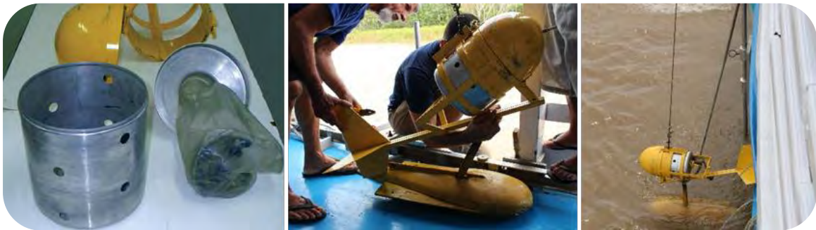
Photographie 2.2: Echantillonneur à intégration AMS-8 de l'ANA au Brésil, conçu pour les grandes rivières Amazoniennes, et équipé ici d'un saumon (lest) de 100 kg. Photographies extraites du rapport de campagne de mesure de Filizola, Armijos et Sampaio (2016) .
