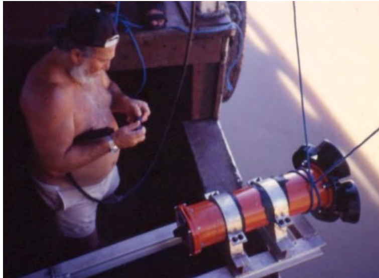
Photographie 1.3: L'un des tout premiers aDcp déployé dans le bassin Amazonien par l'équipe HiBAm. (Guyot et al. , 1998; Filizola et Guyot, 2004).
