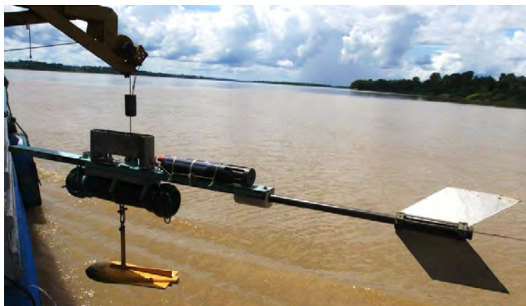
Photographie 1.4: L'un des échantillonneurs ponctuels de type « Callède » utilisé durant les campagnes HiBAm entre 1994 et 2003, puis durant les campagnes du SO HyBAm de 2003 à 2014.
