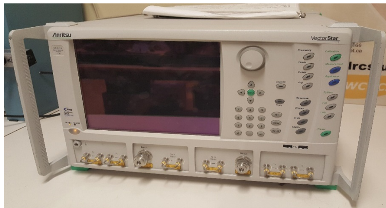
Fig. III.3. Banc de mesure : Analyseur de réseaux ANRITSU MS4647A.
