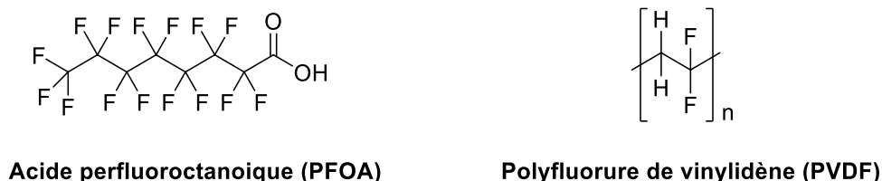
Schéma I-7. Structures chimiques du PFOA et du PVDF.
